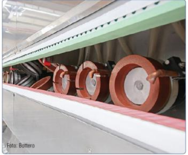
KOLLMORGEN sürücülerini, cam levhalarının doğru bir şekilde konumlandırılmasını ve taşlama çarklarının sürülmesini sağlıyor.
